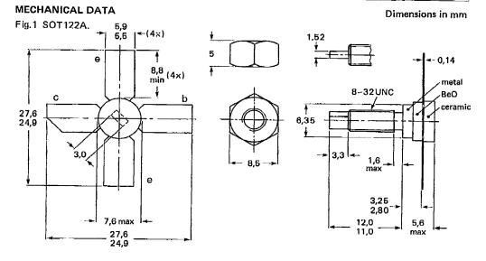
Torque on nut: min. 0,75 Nm (7,5 kg cm) max. 0,85 Nm (8,5 kg cm)
